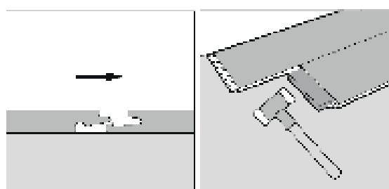
Wenn zwei Seiten verriegelt werden müssen oder das Winkeln nicht möglich ist, verwenden Sie die Klopfmethode. Falls möglich, verriegeln Sie zuerst eine Seite durch Winkeln. Das Klopfen ist an der langen und kurzen Seite möglich. 1. Verwenden Sie einen Schlagklotz und setzen Sie ihn am Verriegelungssystem an. 2. Klopfen Sie vorsichtig mit einem Hammer auf den Klotz, bis sich die Paneele in wenigen Schlägen verbinden.
