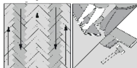
Vervollständigen Sie die erste V-Reihe mit kompletten Platten. Achten Sie darauf, dass sie an der Mittellinie ausgerichtet sind. Fahren Sie dann mit den Seiten fort und arbeiten Sie in umgekehrter Richtung. Um die nächste Reihe zu verlegen, verbinden Sie immer die lange Seite der neuen Platte mit den bereits verlegten Platten. Verwenden Sie einen Schlagklotz, um die kurze Seite der Platte zu schließen.
